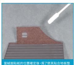
當絨面貼紙的位置確定後,為了使其貼合地板墊的凹凸面,請使用棉花棒等工具輕輕按壓貼合,勿來回摩擦。
